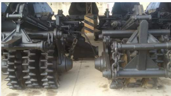
Equipo barreminas que se adiciona al Tanque T - 55.
